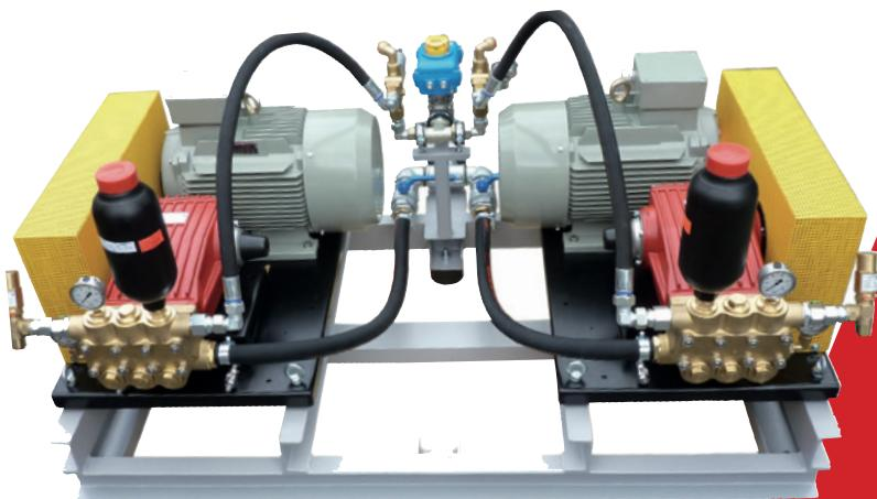
Vom kleinen Pumpenaggregat mit 24V-Antrieb für Meerwasserentsalzung (solargespeist) über kompakte RO-Aggregate zur Most- und Weinbehandlung bis zur großen Galvanikwasseraufbereitung können auf das Medium abgestimmte Anlagen gebaut werden. Beständige Pumpenwerkstoffe gegen aggressive Medien, Sperrwasservorrichtung oder Fremdspülung bei auskristallisierenden Medien, Pulsationsdämpfung, Schallschutz etc. sind auf Kundenwunsch lieferbar.
