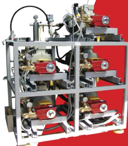
Vom Doppelpumpenaggregat als redundante Anlage über Mehrpumpenaggregate zur Versorgung separater Verbraucher bis hin zu zentralen Aggregaten mit Kaskadenschaltung zur Verbrauchsabhängigen Versorgung mehrerer Verbraucher können kundenspezifische Lösungen angeboten werden. Drehzahlregelung, Steuerung, Puffertank mit Filtration und vieles mehr sind in unserem Lieferprogramm.
